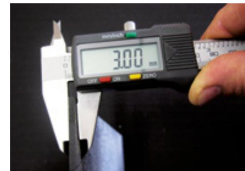
Des dalles fines dotées de couches de renforcement type treillis de matériaux polymériques, nattes, etc. peuvent présenter des facteurs critiques possibles liés à leur comportement au contact avec les adhésifs et les matériaux sur lesquels l'application est prévue. Ces indications sont également valables pour les mosaïques montées sur treillis.
